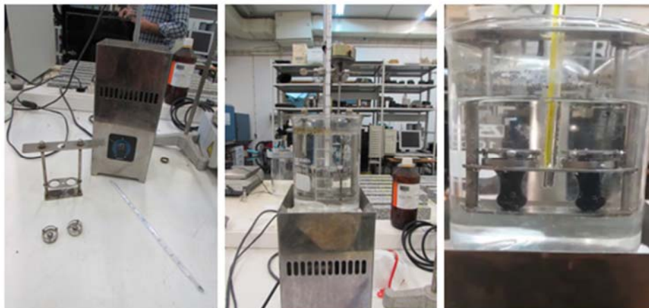
Figura 3.4 – Equipamento do Ensaio para a determinação do Ponto de Amolecimento
