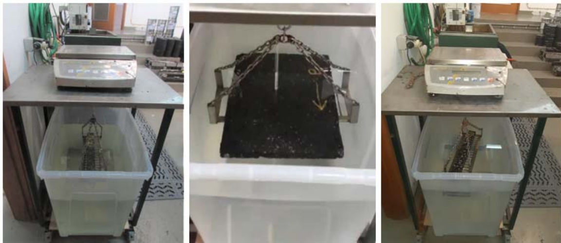
Figura 3.13 – Determinação da baridade dos provetes ( m_2 )
