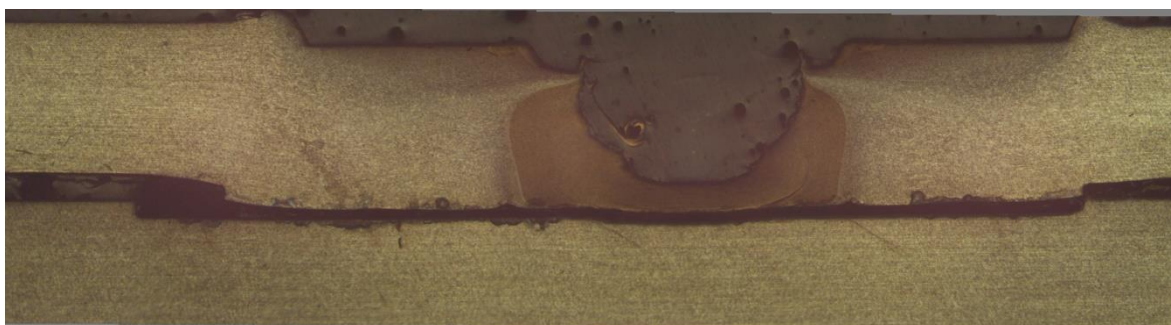
Figura 4.7 – Macrografia do provete híbrido H-2.6.
