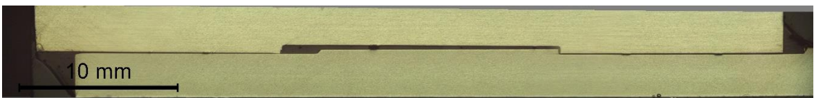
Figura 4.3 – Macrografia do provete colado B-2.6.
