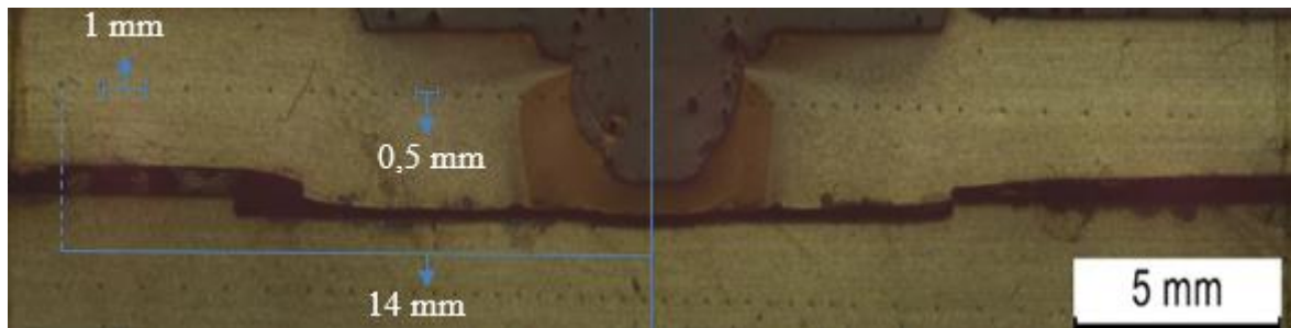
Figura AG 0.1 – Identificação dos pontos na amostra onde foram efetuadas as indentações
