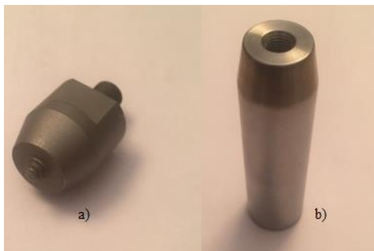
Figura 3.1 – Ferramenta FSSW a) e fixador b).
