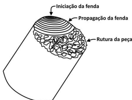
Figura 2.1. Ilustração dos três estágios da falha por fadiga (adaptado de Almeida, 2018)
