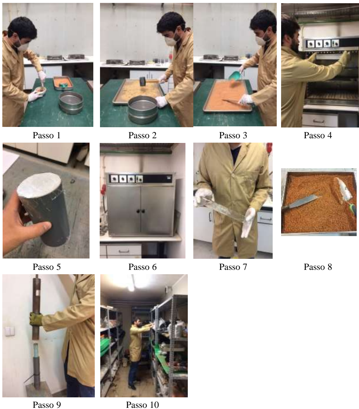
Figura 4.2 - Ilustração passo-a-passo da preparação dos provetes de solo.
