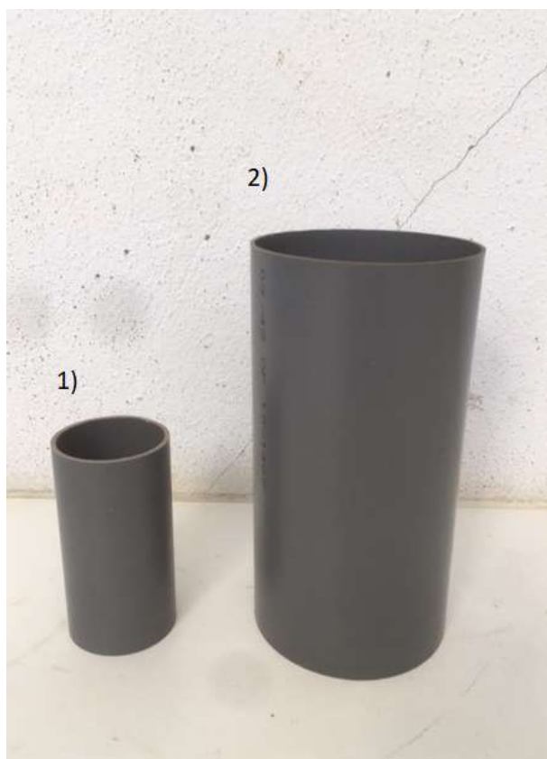
Figura 4.1 - Legenda dos provetes utilizados na montagem da amostra para o ensaio UCS e para o ensaio edométrico.
