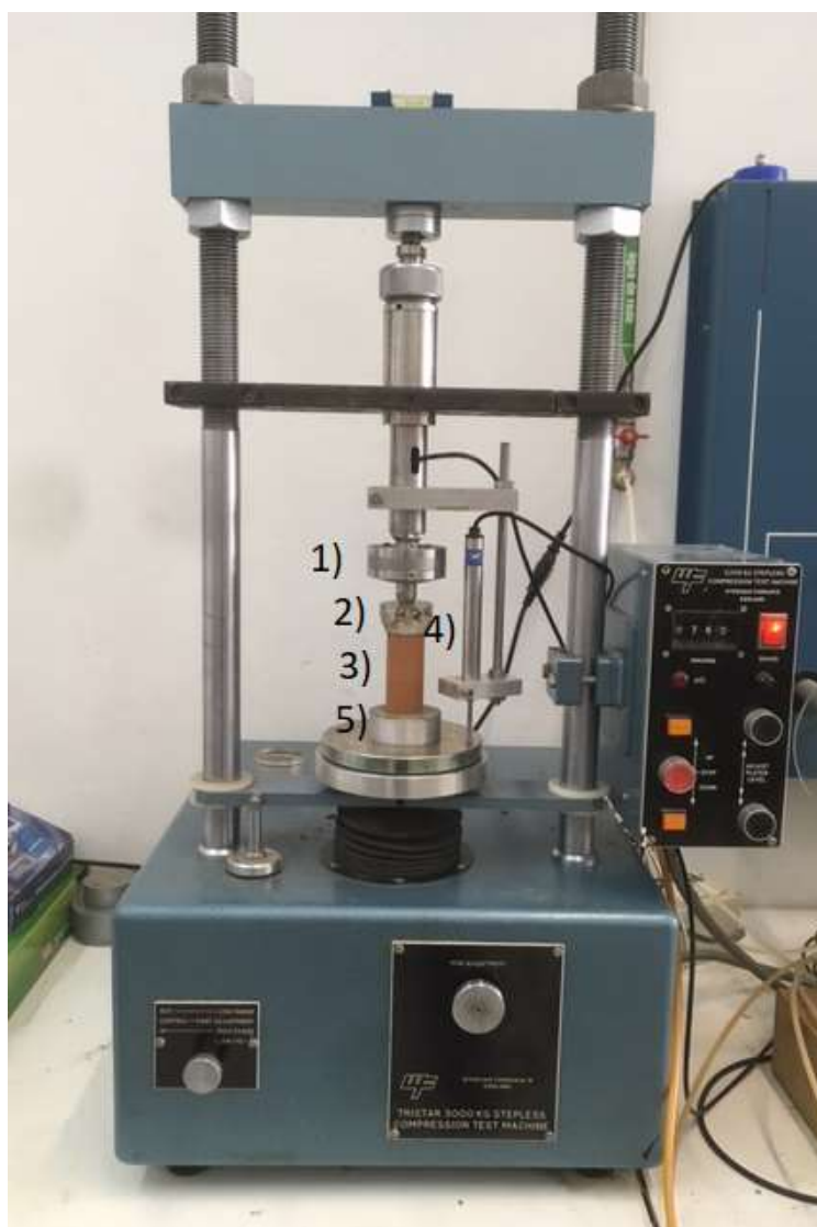
Figura 4.4 - Legenda da prensa usada nos ensaios UCS.
