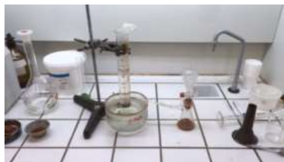
Figura 4.10 - Sistema de medição do carbonato de cálcio: a) Esquema teórico (Neupane et al., 2015); b) Esquema real.
