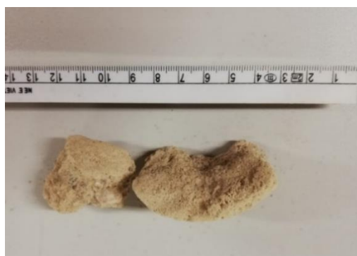
Figura 29 - Arenito argiloso da base do intervalo entre os 7,50 e os 9,00 m, da sondagem 2019S1.
