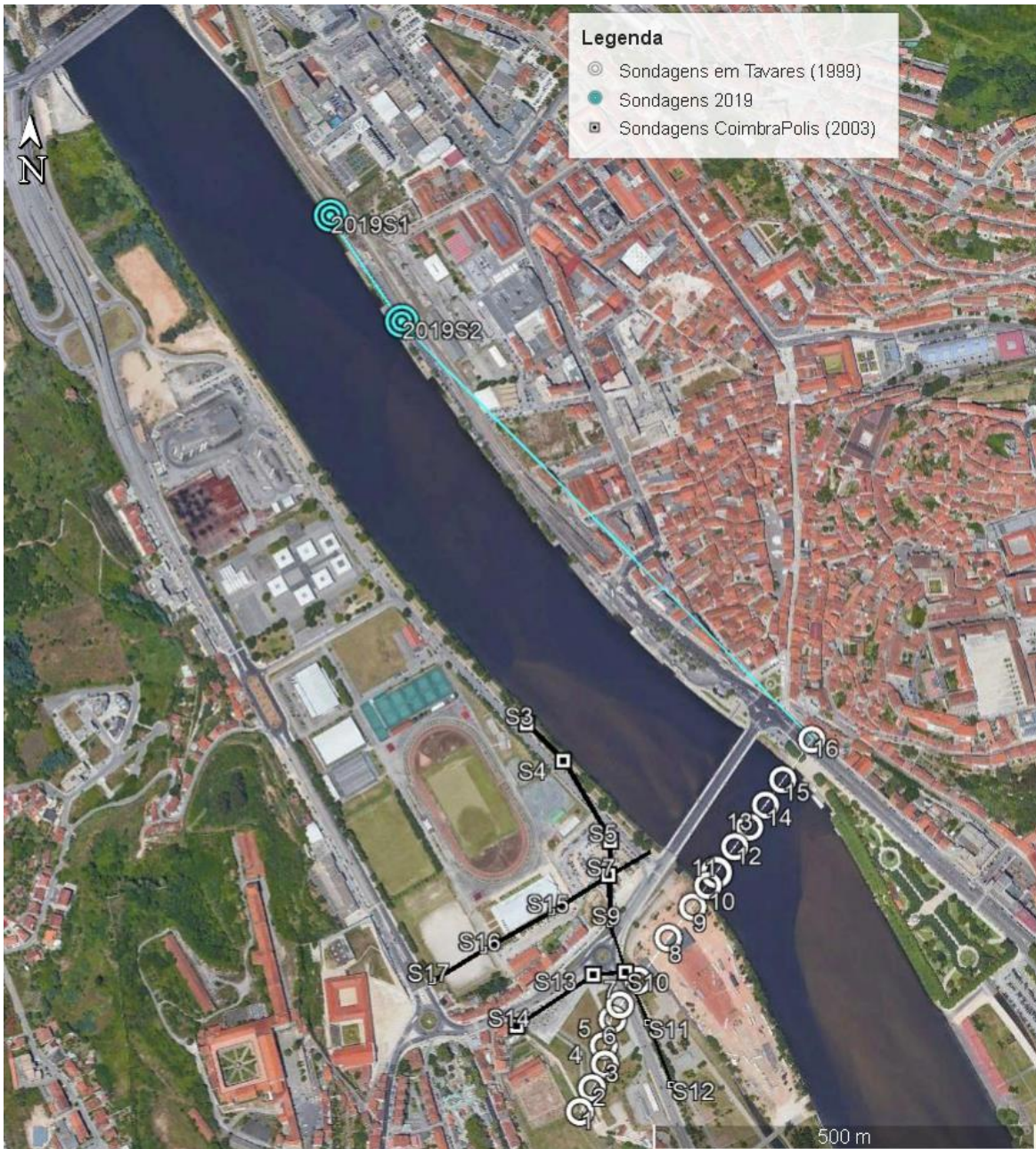
Figura 63 - Localização dos perfis de sondagens realizadas em 2019 (a azul claro), as presentes em aTavares (1999) (a branco) e as de CoimbraPólis (2003) (a preto). Os traços com as respetivas cores das sondagens, representam os perfis realizados em cada uma delas.
