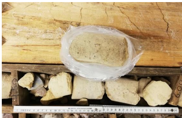
Figura 24 - Material presente no intervalo entre os 4,50 m e os 6,00 m. Tarolos, incluindo o dentro do saco, pertencem às amostras colhidas nos tubos.
