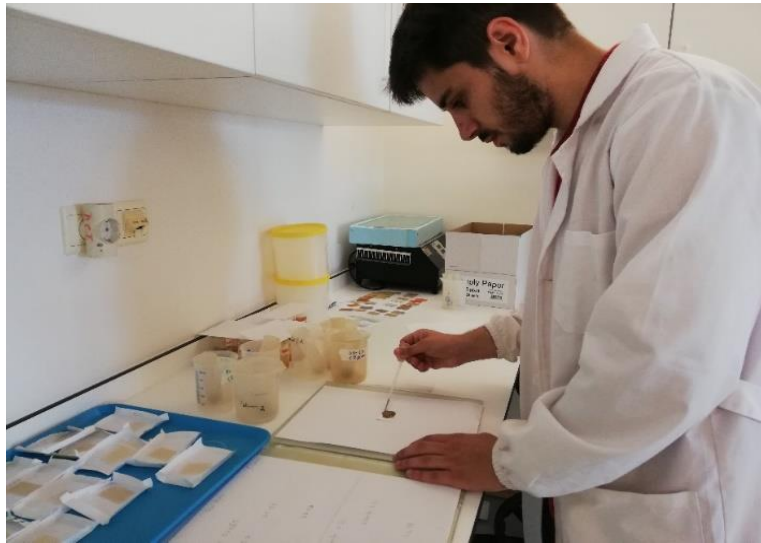
Figura 15 - Pipetagem de amostra para lamina, para realização de lâmina sedimentada.
