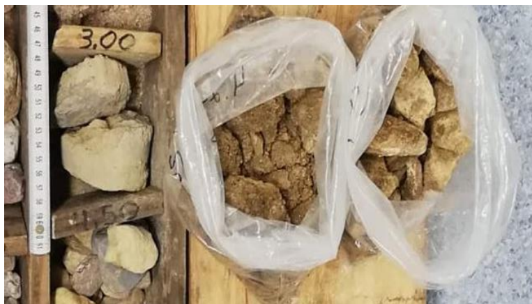
Figura 19 - Intervalo dos 3,00 m aos 4,50 m. As Amostras nos sacos, são o material colhido nos tubos.
