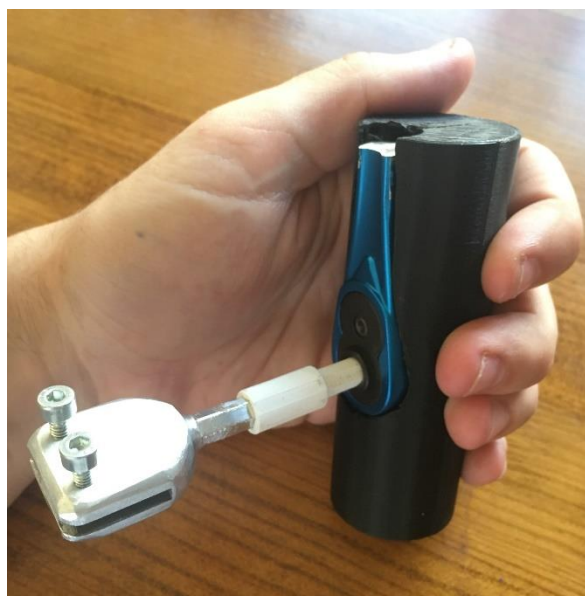
Figura 3.6.- Conjunto dos componentes: base cilíndrica-roquete-prolongador-peça metálica
