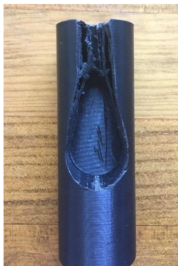
Figura 3.8. - 1ª base cilíndrica após desbaste
