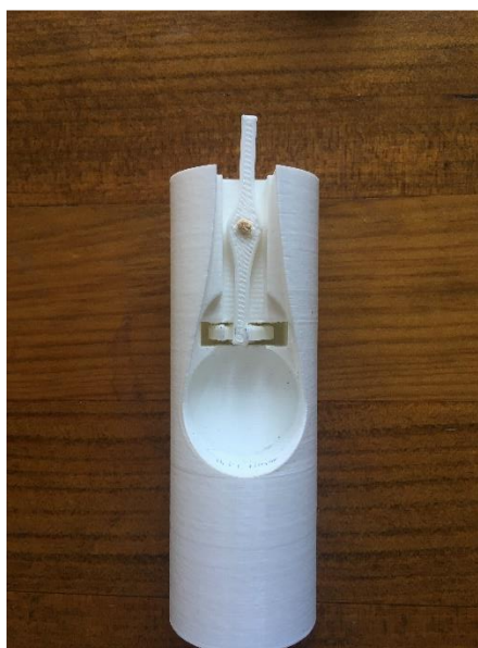
Figura 3.12.- Conjunto do terceiro produto: base cilíndrica-alternador de sentido-roda
