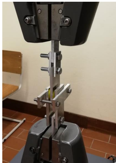
Figura 4.3. Mecanismo implementado em laboratório numa máquina de tração universal.
