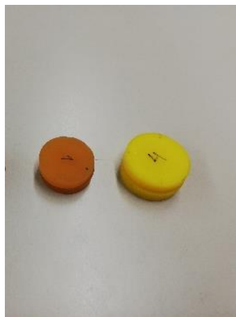
Figura 4.1. Provetes de poliuretano, PUR70 (amarelo) e PUR95 (cor de laranja), usados nos ensaios laboratoriais.
