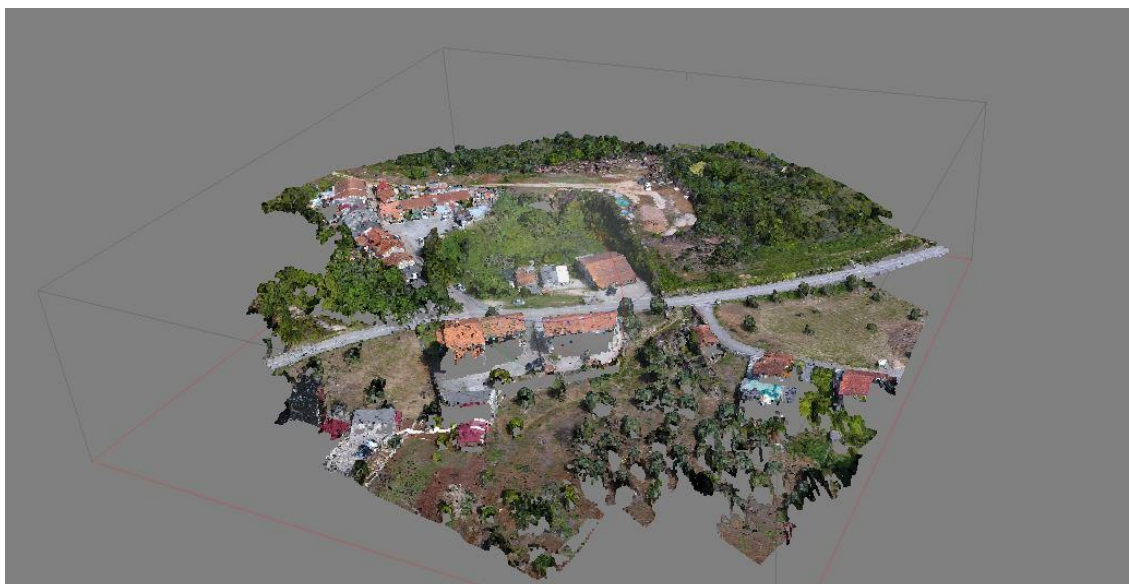
Figura 42. Construção da nuvem densa de pontos
