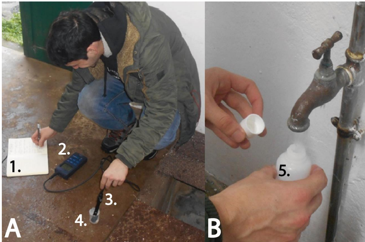
Figura 1.2: Ensaio e medições de campo. (A - Análise físico-química da água (in situ); B - Amostragem de água. 1. - Caderno de campo; 2. - Condutivímetro (Modelo: WTW: pH/Cond 3320); 3. - Sensor incorporando células de medição de condutividade elétrica; 4. - Pequeno copo com água colhida no local para medição in situ; 5. - Recipiente de polietileno).
