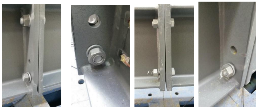
Figura 3-35 – Ensaio da ligação L2 - Rotura do parafuso
