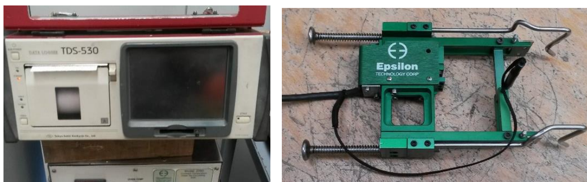
Figura 3-5 – Sistema de aquisição de dados e extensómetro mecânico
