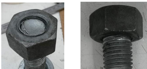
Figura 3-25 – Rotura do parafuso
