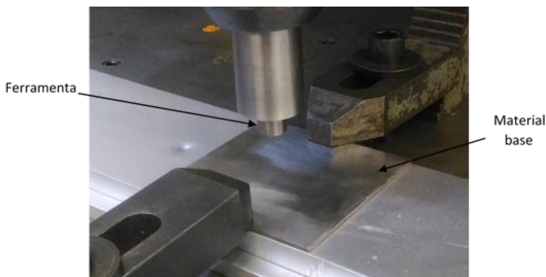
Figura 3.3. Montagem das chapas de material base para a produção das soldaduras
