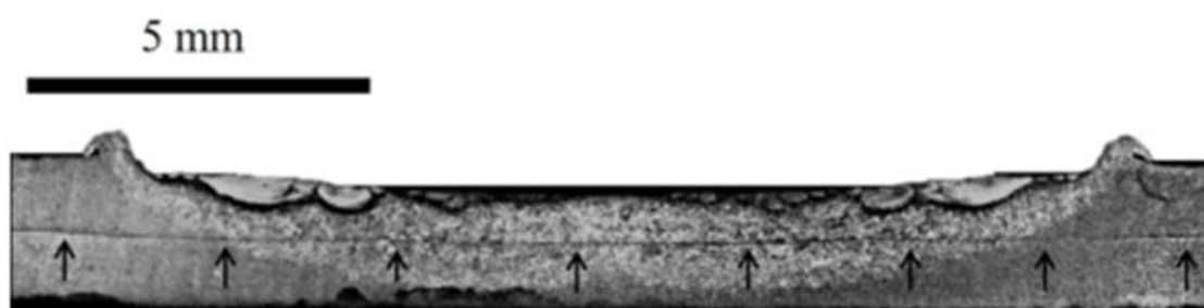
Figura 2.4. Secção transversal do perfil de soldadura por TAFSW em aço DC01 (Diâmetro da ferramenta de 12mm, \omega=1140\text{rpm} e dz=0,5\text{mm} ) (adaptado de Andrade et al. , 2019)
