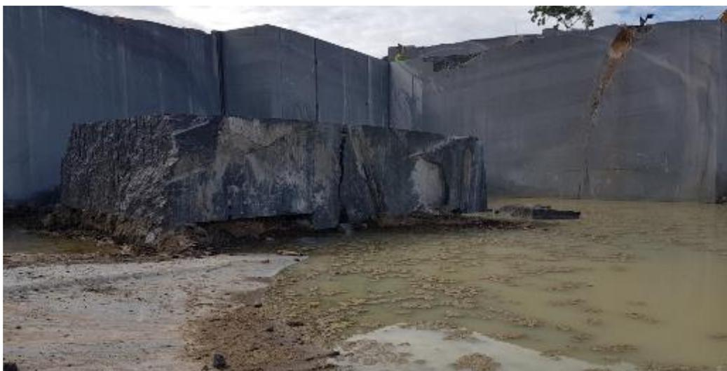
Figura 16 Talhada derrubada sobre acamamento, na frente de trabalho 8 da Pedreira Rodang-Mina 2.
