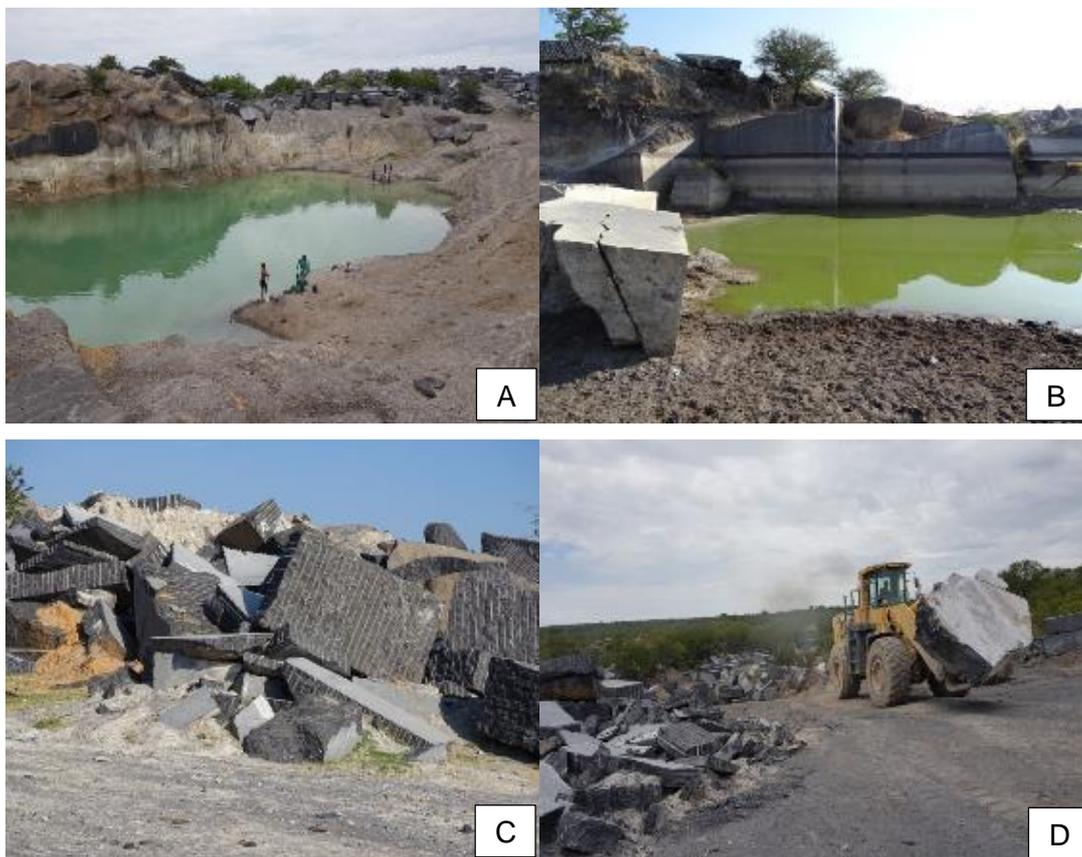
Figura 29 A e B) Frentes de trabalho 1 e 4, desativadas, C) Blocos de anortosito empilhados na frente de trabalho 4, desativada e D) Aspeto da escombrelira.
