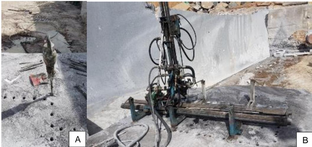
Figura 17 A) Martelo pneumático e B) perfuratriz hidráulica na atividade de esquadrejamento de talhada para obtenção de blocos com dimensões comerciais.
