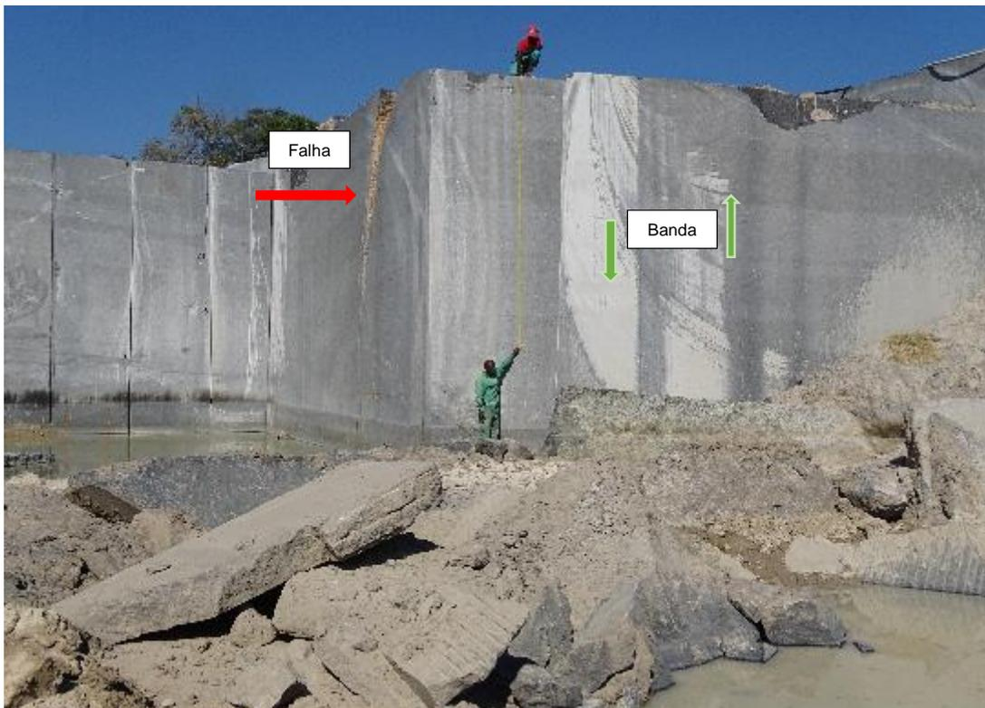
Figura 25 Frente de trabalho 8, piso 2, com altura de cerca de 13,40m, com presença bandas fraturas.
