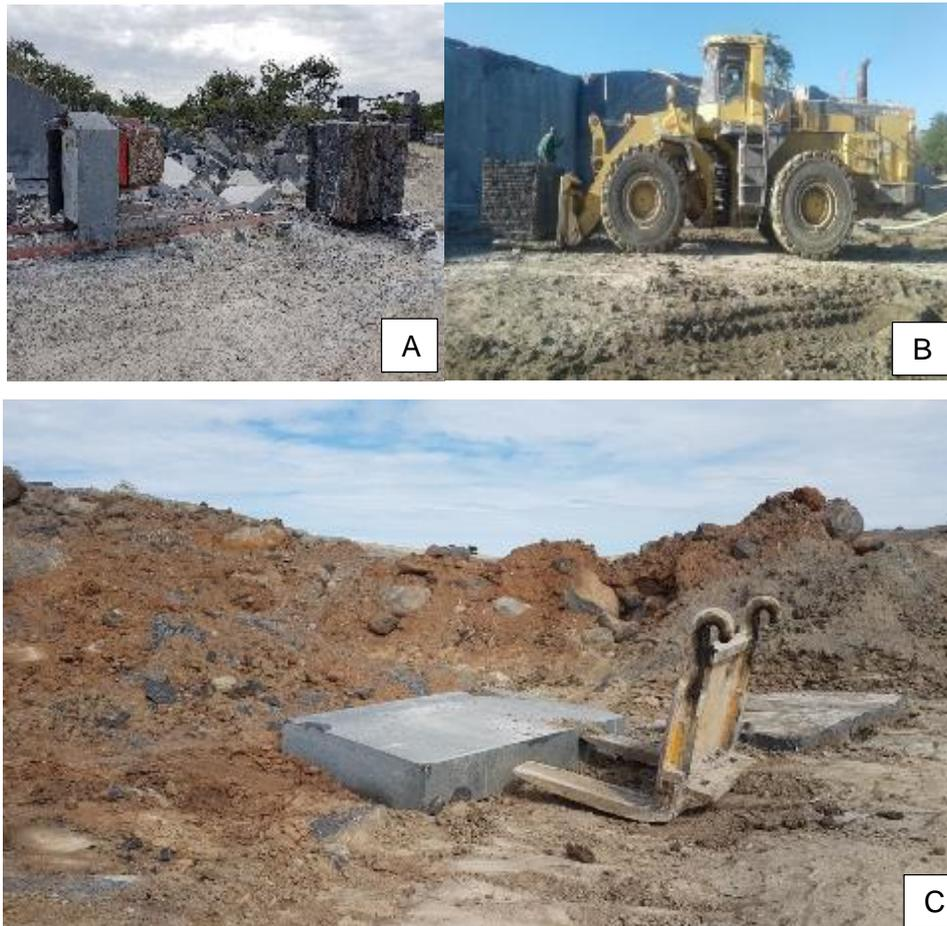
Figura 18 A) Máquina de monofio diamantado efetuando o redimensionamento do bloco, B) Transporte de bloco pela pá carregadeira com ripper e C) Ripper desacoplado e talhada para transporte.
