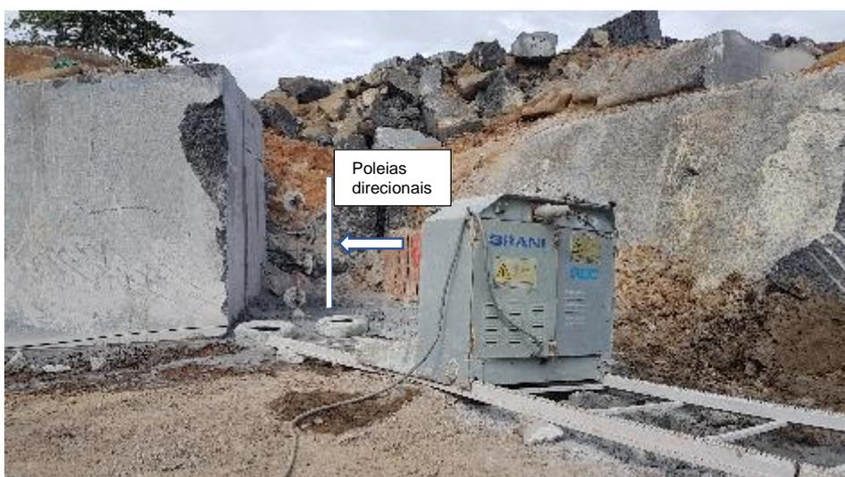
Figura 15 Máquina de monofio diamantado com poleias direcionais a executar o corte vertical.
