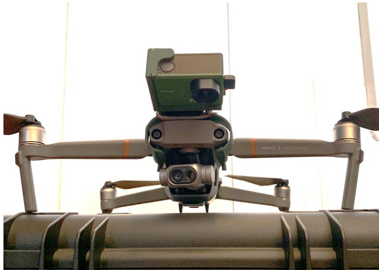
Fig. 29 - Câmara de infravermelhos acoplada ao drone DJI Mavic 2 Enterprise Dual
