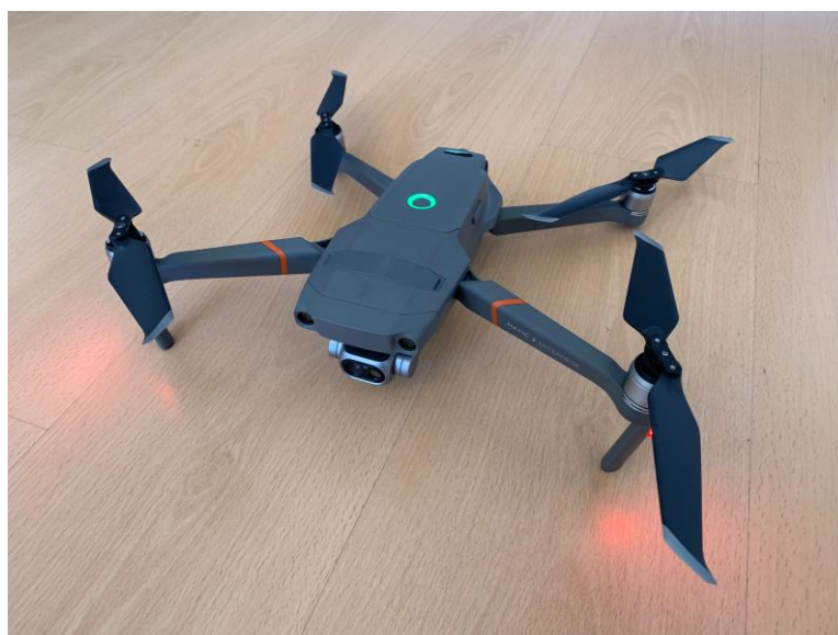
Fig. 28 - RPA utilizado para aquisição de dados – DJI Mavic 2 Enterprise Dual
