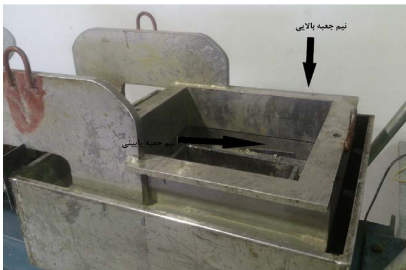
شکل ۱۵-۳ شمایی از نیم جعبه بالایی و پایینی بکار رفته در دستگاه برش مستقیم
