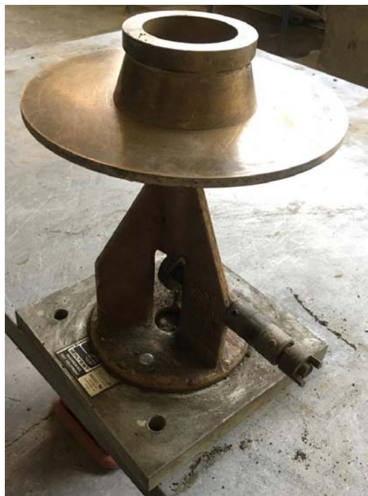
شکل ۳-۶ میز جریان مورد استفاده در پژوهش
