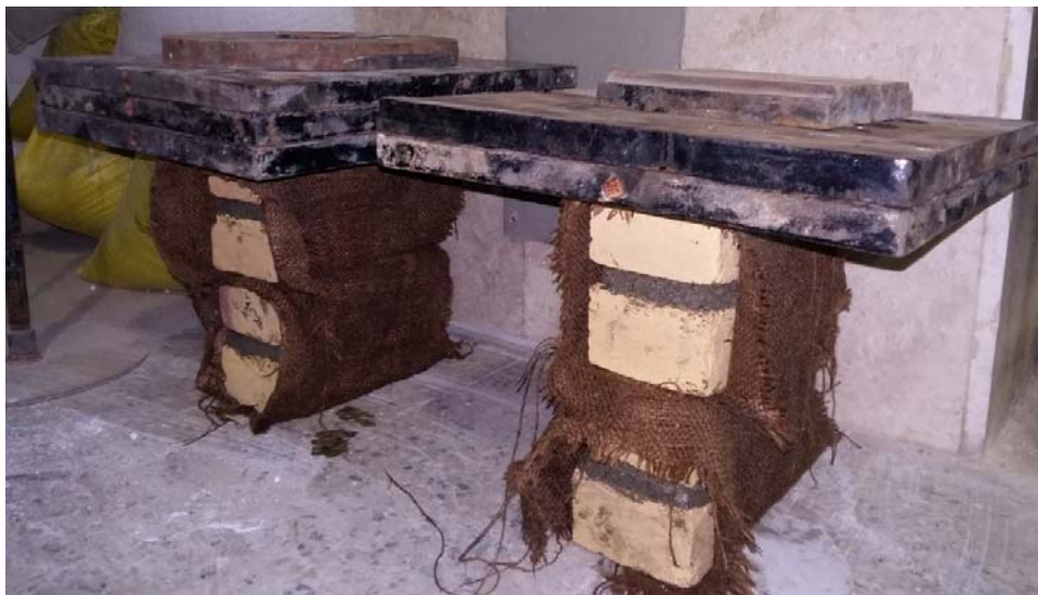
شکل ۳-۱۴ اعمال بار بر روی نمونه‌ها در زمان عمل‌آوری
