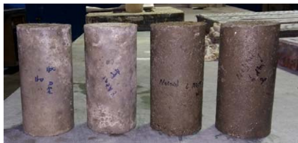
شکل ۳-۷ نمونه‌های استوانه‌ای ساخته شده جهت تست بر روی ملات
