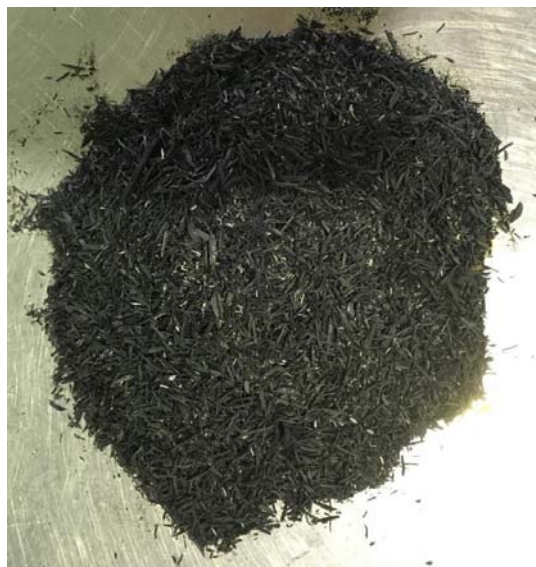
شکل ۳-۴ تصویری از خاکستر پوسته برنج نوع I
