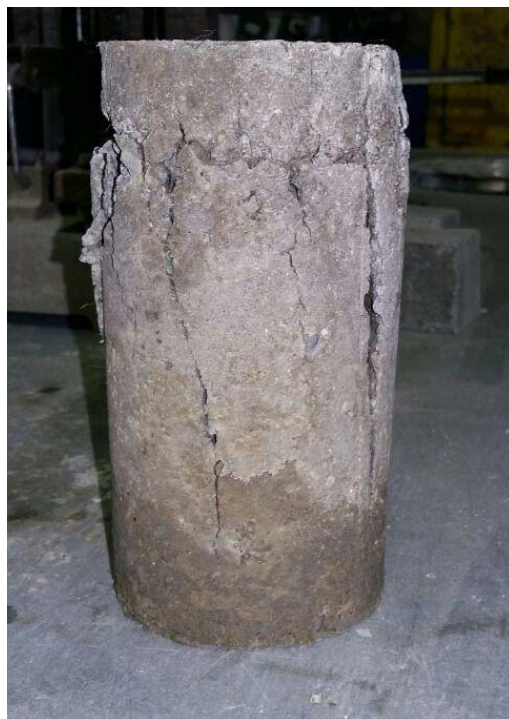
شکل ۳-۹ نمونه تست شده در تست مقاومت فشاری
