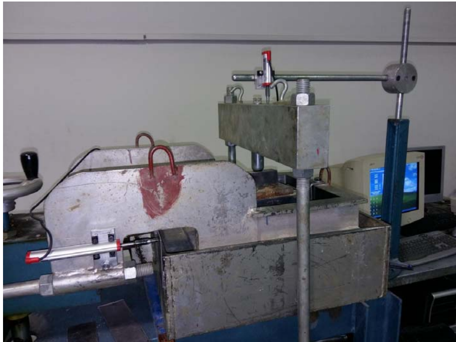
شکل ۱۸-۳ چگونگی استقرار جابجایی سنجها بر روی دستگاه
