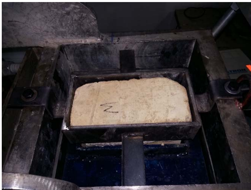
شکل ۳-۱۷ قرارگیری قالب‌های بالایی و پایینی به همراه نمونه درون دستگاه
