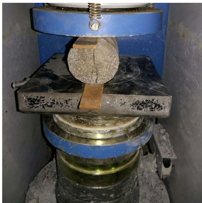
شکل ۳-۱۰ نمونه تست شده توسط تست مقاومت کششی
