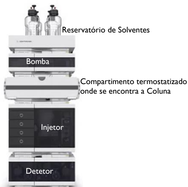
Figura 6 - Componentes básicos de um sistema HPLC/UHPLC (Adaptado de [19]).
