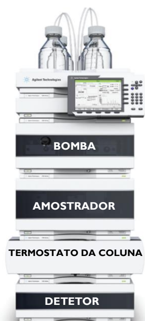
Figura 12 - Sistema LC 1290 Infinity II com ISET (Adaptado de [19]).
