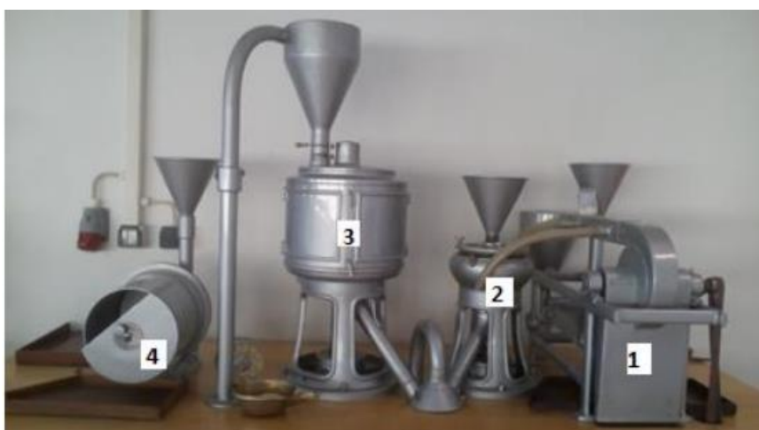
Figura 7 - Equipamento laboratorial para descasque e branqueamento de arroz. (1-Tarara; 2-Descascador; 3-Branqueador; 4-Trior) (Garcia, 2017).
