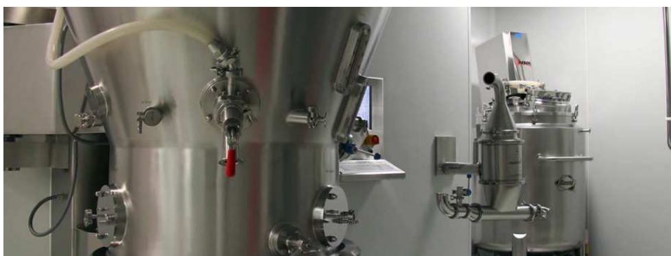
Figura 2 - Estufa de leito fluido DIOSNA®, adaptado de (3).
