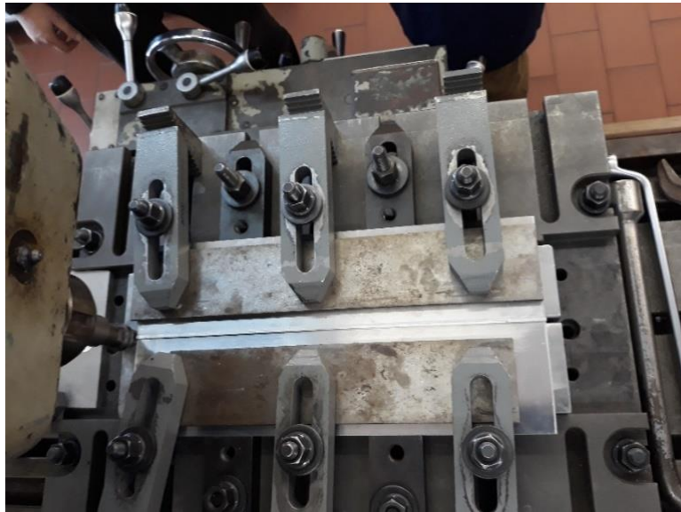
Figura 3.2. Sistema de fixação das juntas.
