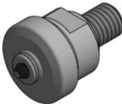
Figura 3.3. Ferramenta progressiva cónica roscada (adaptada de Gruppelaar, 2015).
