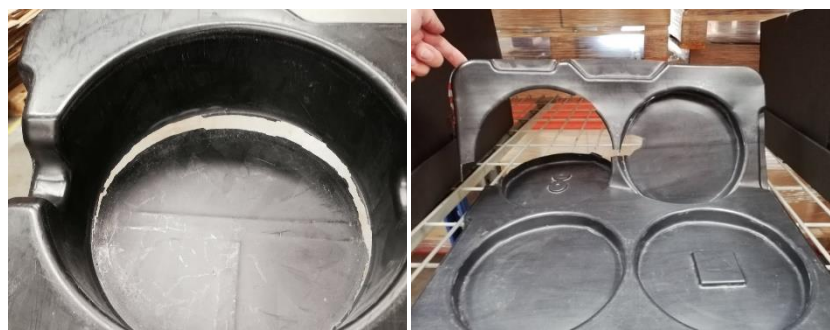
Figura 16 - Exemplos de blisters danificados
