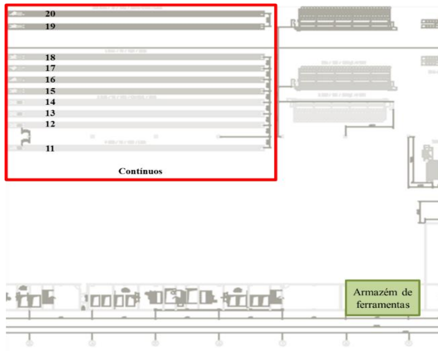
Figura 6.2 – Layout parcial da fiação com a eliminação do armazém de carretos
