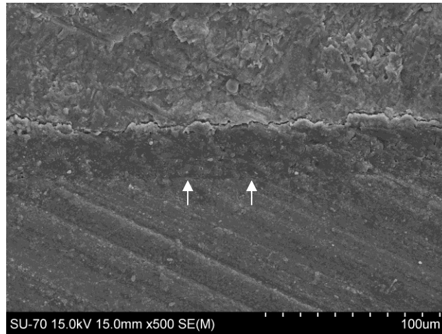
Figura 2. 31 - Imagem de MEV onde é possível observar a interface adesiva esmalte / PB XP / resina composta, referente ao grupo I. Observam-se zonas de descolamento entre o adesivo e a resina composta, uma camada adesiva uniforme com cerca de 30 \mu\text{m} de espessura e uma interface esmalte/adesivo regular e sem defeitos (setas) (ampliação de 500x).
