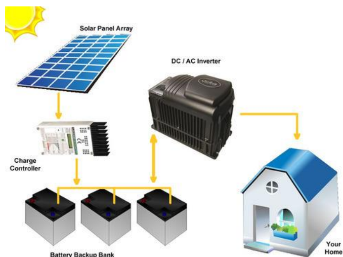
Figura 3 - Sistema isolado com uso de painéis fotovoltaicos [25]
