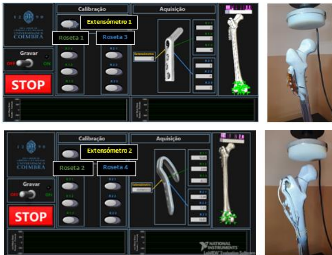
Figura 3.14. Painel frontal do programa em LabVIEW ® e placas DHS e TPC instrumentadas no osso.
