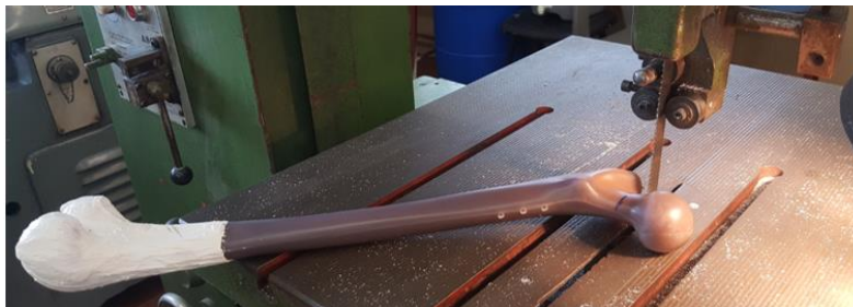
Figura 3.10. Osso sintético com silicone aplicado, pronto a ser cortado na região do colo do fêmur.
