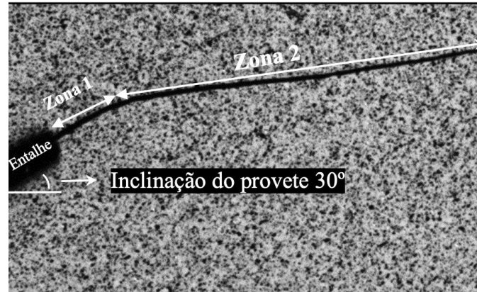
Figura 16. Deflexão e modos de propagação, \alpha=30^{\circ} .
