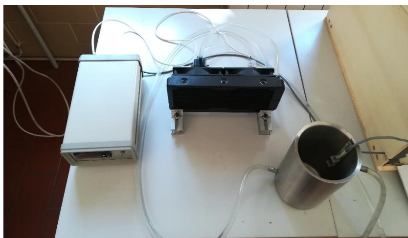
Figura 22 - Circuito de refrigeração construído
