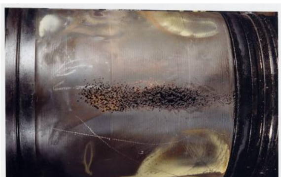
Figura 4 - Paredes de um cilindro com danos causados por cavitação, CONSTRUCTIONEQUIPMENT, 2018.
