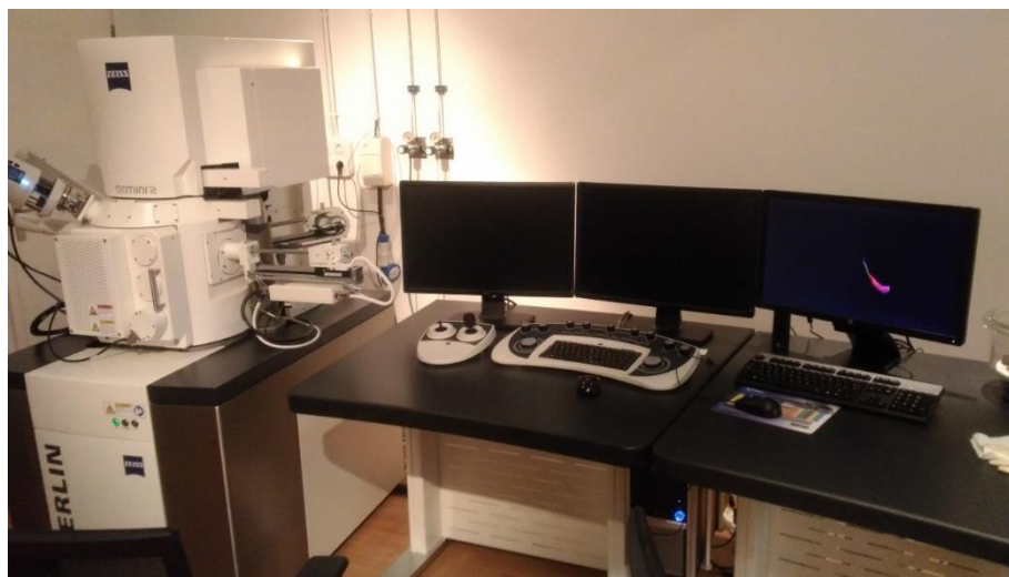
Figura 23-Microscópio de varrimento eletrónica usado para avaliação da composição química e morfologia dos revestimentos.
