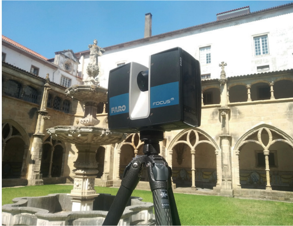
Fig. 4 - Laser scanner (FARO Focus M 70) do Projeto Santa Cruz, durante levantamento ao Claustro do Silêncio do antigo mosteiro de Santa Cruz, em Coimbra.
