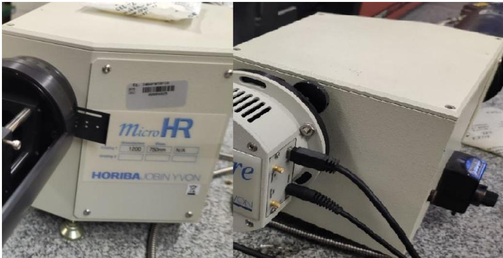
Figura 2.14 – Monocromador MicroHR montado no laboratório
