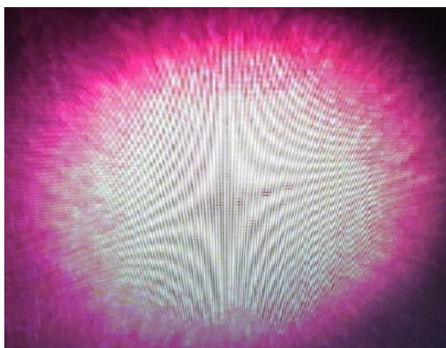
Figura 4.10 – Feixe de luz laser a irradiar a mostra para posterior focagem
