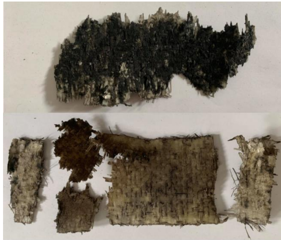
Figura 4.3. Chapa voadora e chapa base do ensaio explosivo EW62.
