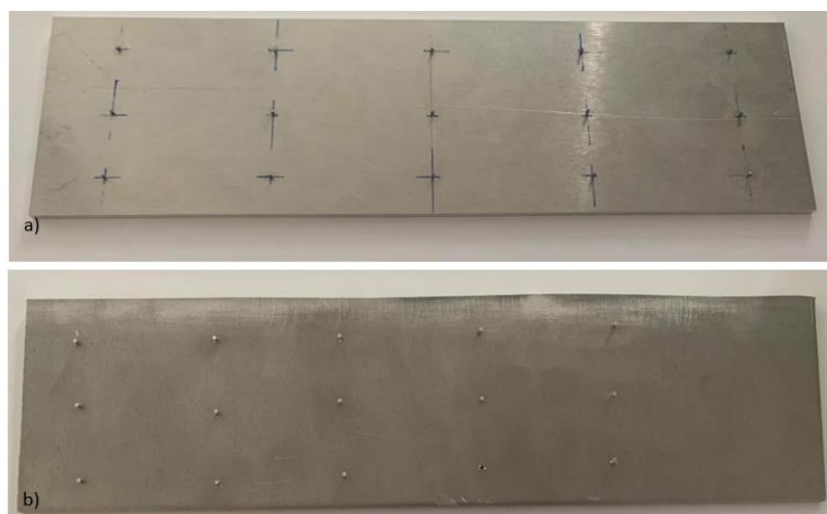
Figura 3.1. Representação dos pinos encastrados e soldados: (a) pinos de alumínio soldados na chapa voadora do ensaio explosivo 59; (b) pinos de aço encastrados na chapa voadora do ensaio explosivo 61.
