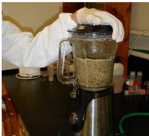
Figura 1- Preparação dos extratos de sargaço: trituração do sargaço na liquidificadora juntamente com a água destilada.
