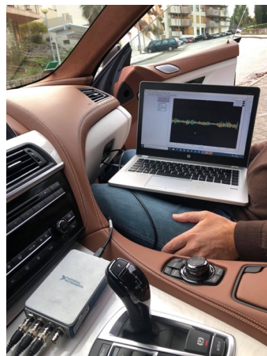
Figura 3.13. Vista detalhada da conexão da placa de aquisição com o computador
