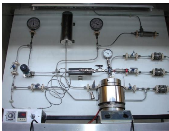
Figura 4.1. Sistema de alta pressão do Departamento de Química da Universidade de Coimbra
