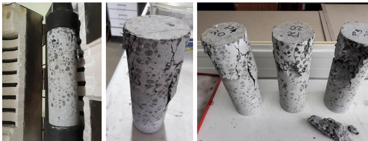
Corpos de prova em LWC fissurado após ensaios em temperatura ambiente
