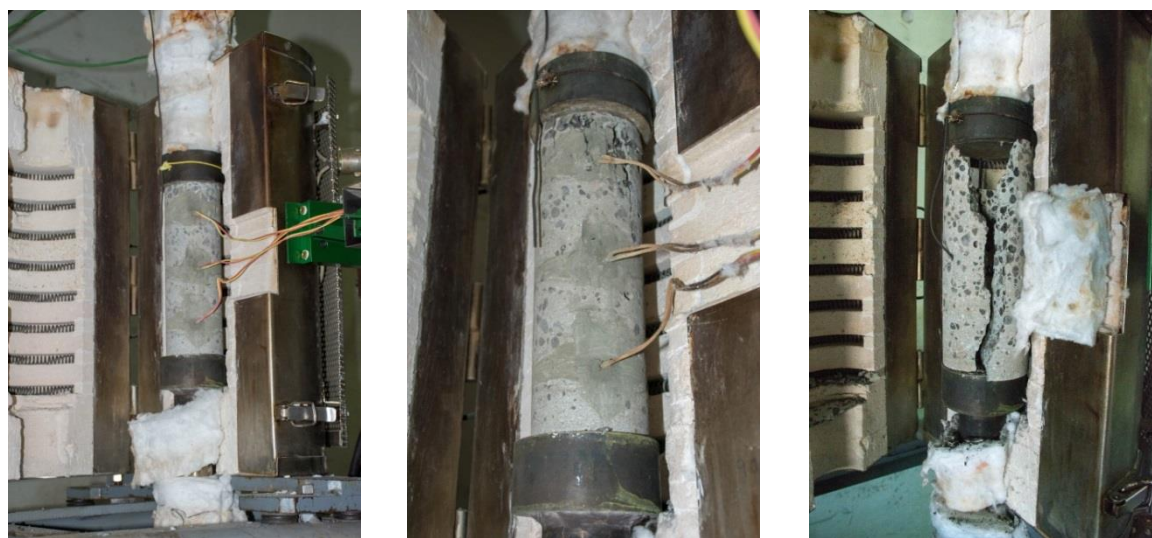
Corpo de prova preparado para o ensaios, com os termopares posicionados
