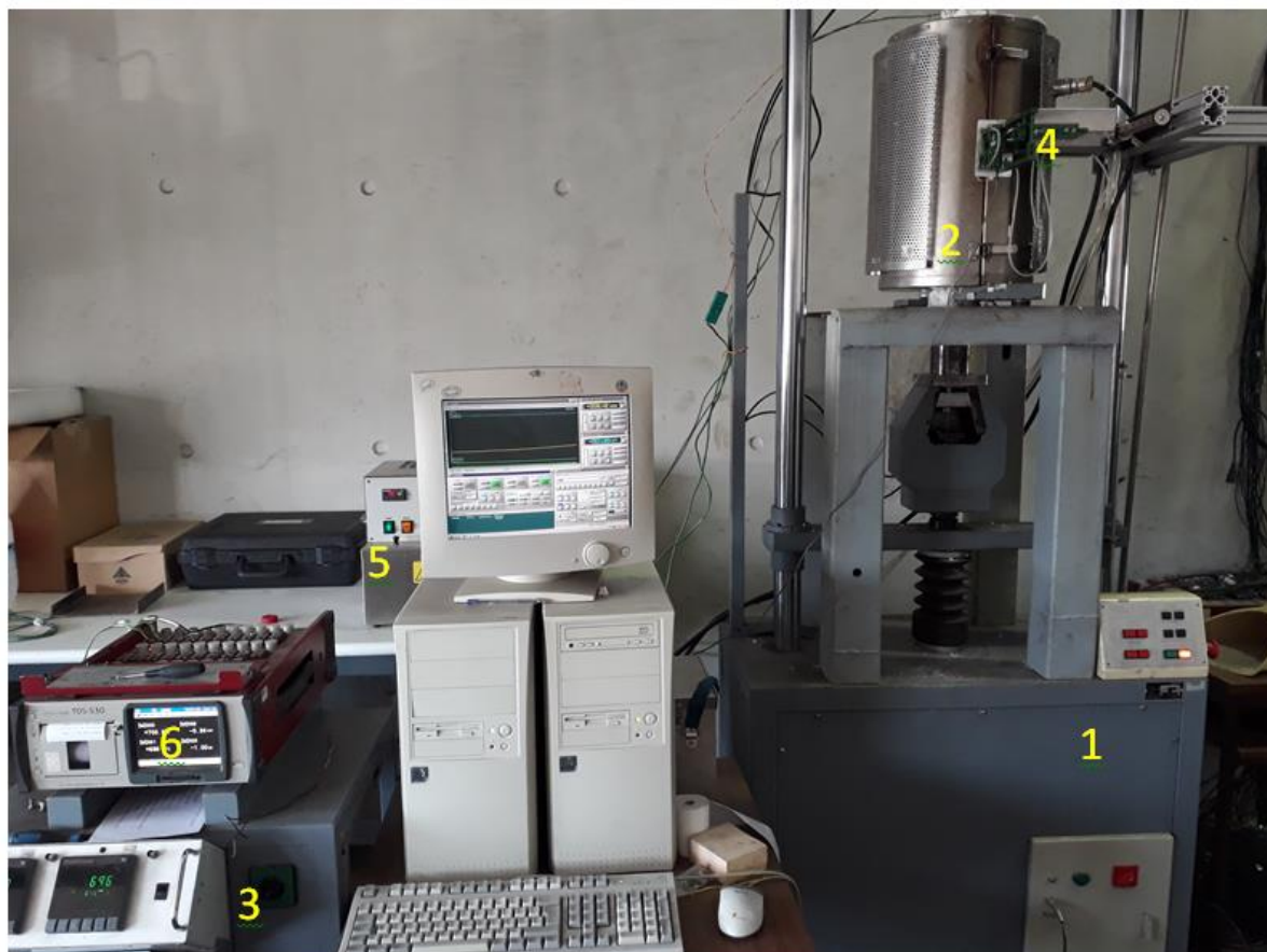
Figura A.1 - Sistema de ensaio de tração a altas temperaturas em corpos de prova de aço e extensômetro refrigerado
