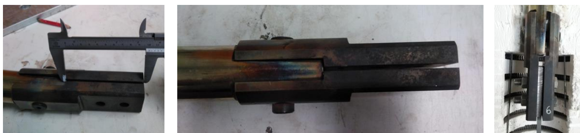
Figura A.3 – Garras para a amarração dos corpos de prova á prensa hidráulica.
