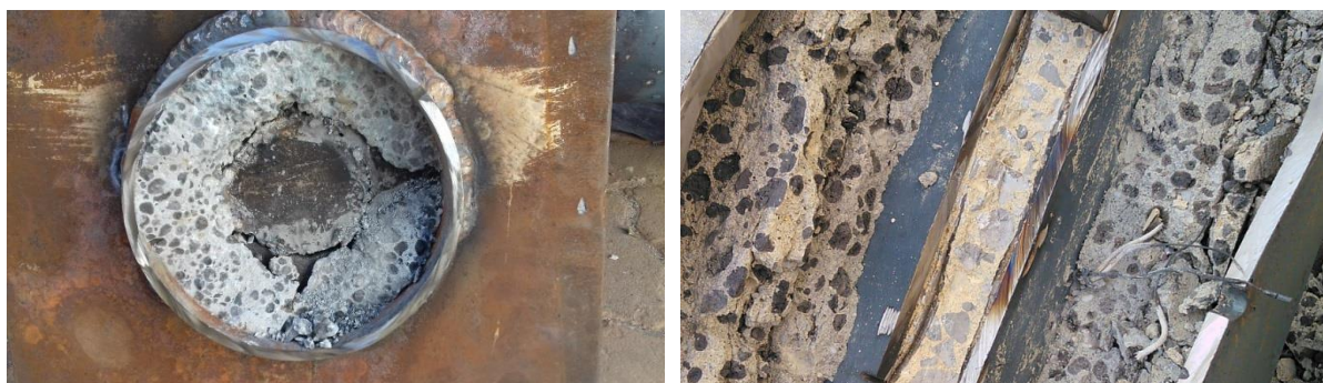
Figura 3.14 - Concreto com agregado de argila expandida após o ensaio.
