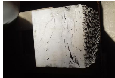
g) Corpo de prova após o ensaio de resistência - LWC
