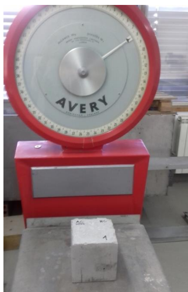
d) Pesagem do corpo de prova PC
