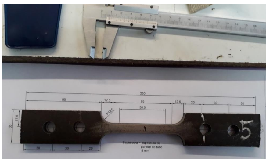
Figura A.4 – Aferição das medidas dos corpos de prova
