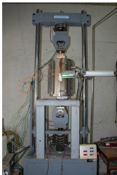
1 - Sistema de ensaio de compressão a altas temperaturas
