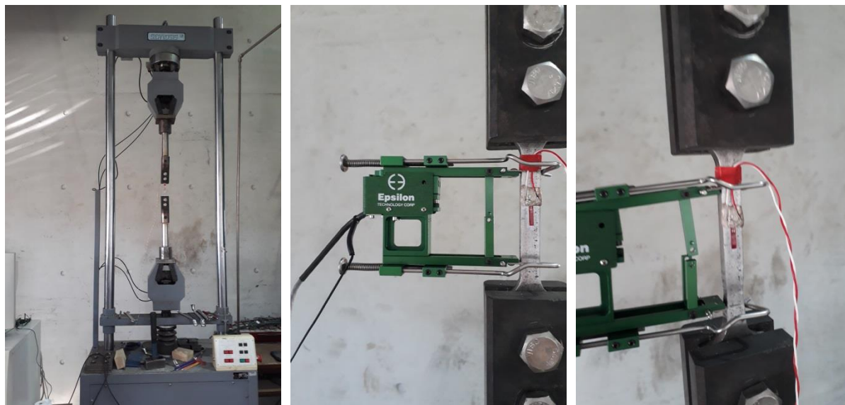
Figura A.6 – À esquerda e no centro, o corpo de prova pronto para ensaio em temperatura ambiente, à direita, o corpo de prova durante o ensaio, com a formação da zona de estricção.
