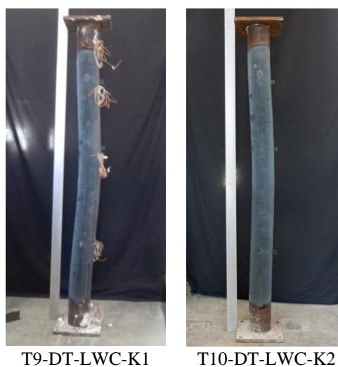
Figura 4.22 - Deformada dos pilares com anel de concreto com argila expandida
