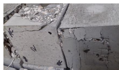
c) Corpo de prova após ensaio de resistência - HSC
