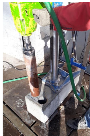
3 – Caroteamento da laje para fabricação dos corpos de prova
