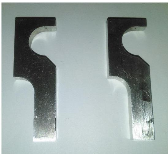
**Figura 2.2** Peças do provete para ensaio de tração.
