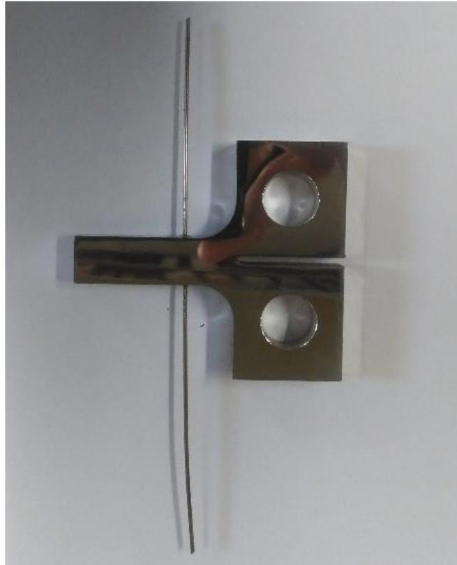
**Figura 2.14** Provete polido e com o fio introduzido, pronto para o ensaio de propagação de fendas.
