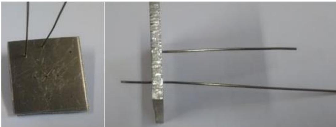
**Figura 2.6** Chapa de liga de alumínio de 3 mm com o fio introduzido.
