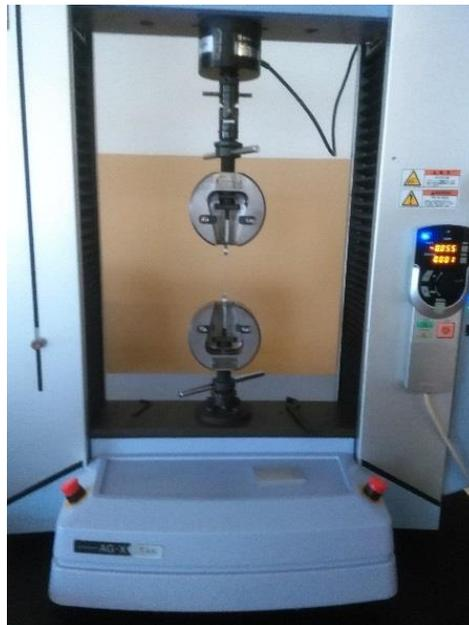
**Figura 2.12** Montagem do ensaio de tração dos provetes com o fio de nitinol introduzido.
