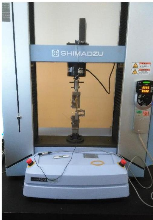
**Figura 2.10** Montagem do ensaio de tração.
