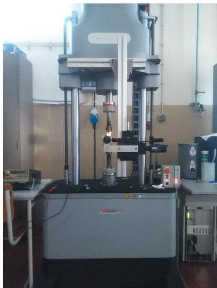
**Figura 2.13** Máquina utilizada para ensaio de propagação de fendas.
