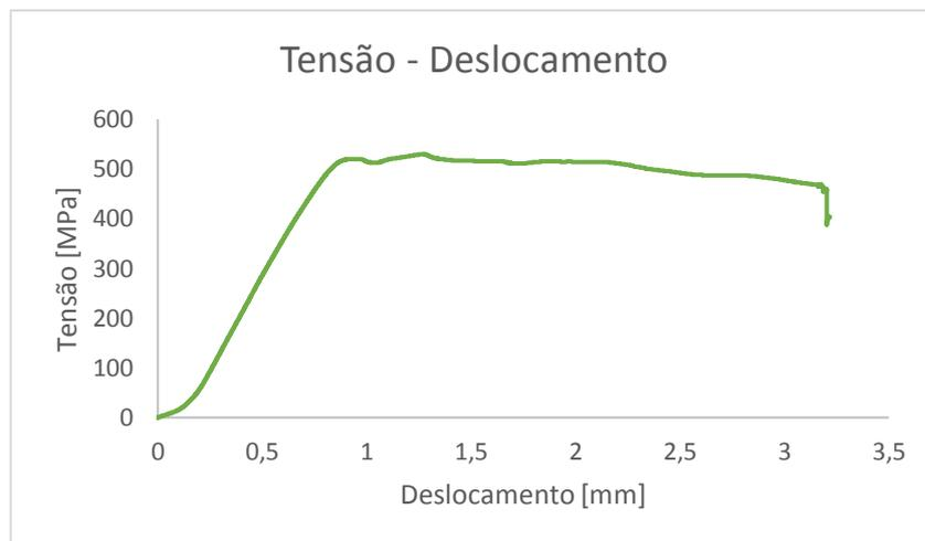
**Figura 3.6** Gráfico Tensão – Deslocamento do ensaio de tração do provete com o fio inserido ao longo de uma espessura de 8 mm.
