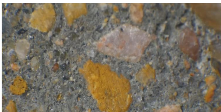
Figura 5 - Ligação estabelecida entre os agregados (imagem adaptada de vídeo [37]).
