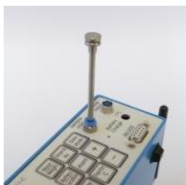
Figura 3.2 - Sistema de recolha da amostra de ar (GRIMM Aerosol Technik GmbH & Co.KG, 2016b).
