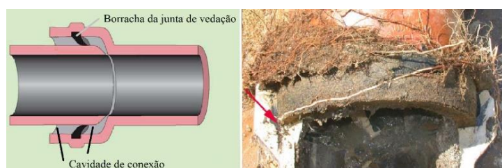
Figura 2.4 – Pormenor da ligação do tubo (esquerda) e observação de crescimento da raiz na cavidade (direita), (Stützel, 2008).
