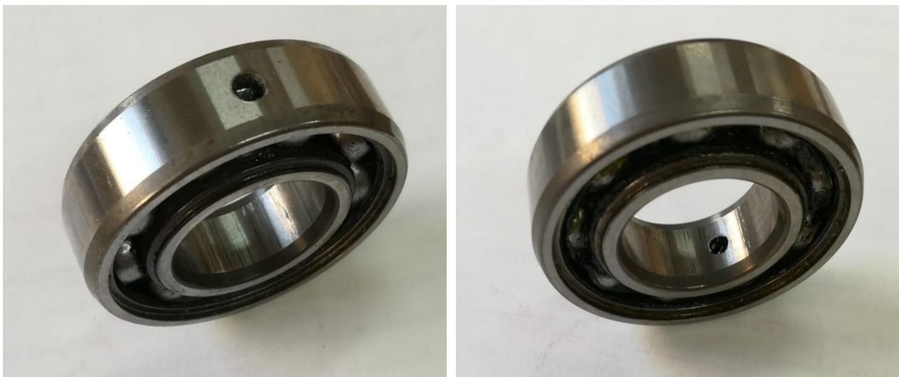
Figura 4.1-2 - Rolamentos com avaria: (a) furo de 4 mm no anel externo; (b) furo de 2 mm no anel interno.
