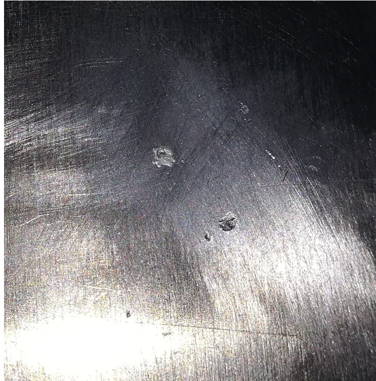
Figura 2.9: Filme de tinta de prata no termopar de filme-fino de 0,7mm de diâmetro.
