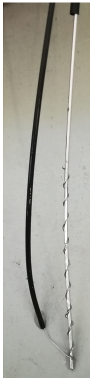
Figura 2.11: Fio de Alumínio e constantan que ficam mergulhados no banho a 0°C.
