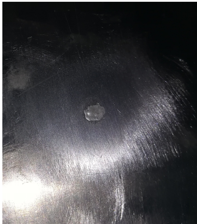
Figura 2.8: Filme de tinta de prata no termopar de filme-fino de 3mm de diâmetro.
