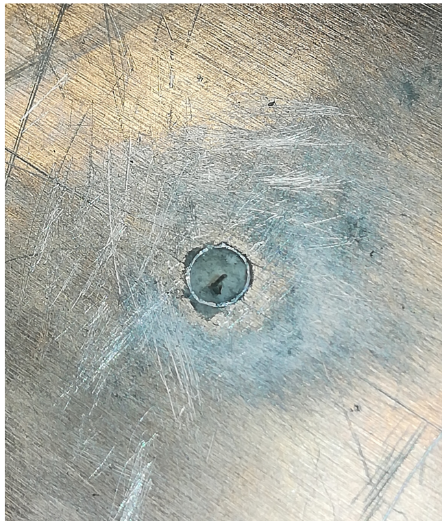
Figura 2.6: Vista superior da placa com o fio de constantan fixo pelo cimento.
