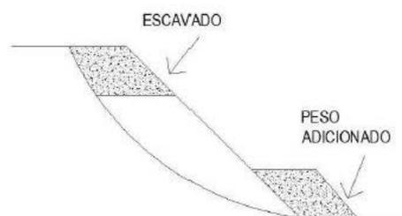
Figura 2.16 - Escavação e aterro no pé do talude
