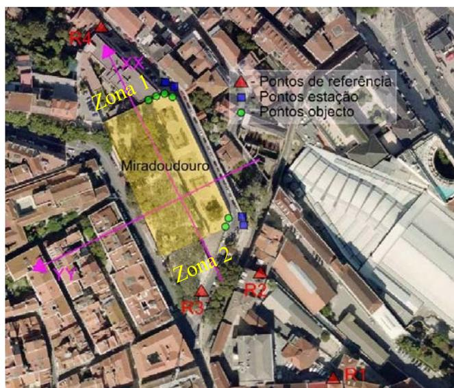
Figura 3.15 - Localização das zonas instrumentadas no muro da plataforma inferior
