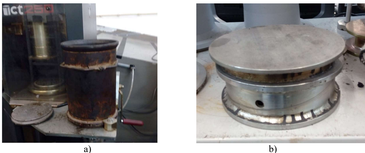
Figura 3.6 - a) Molde do compactador giratório; b) Espaçadores utilizados no processo
