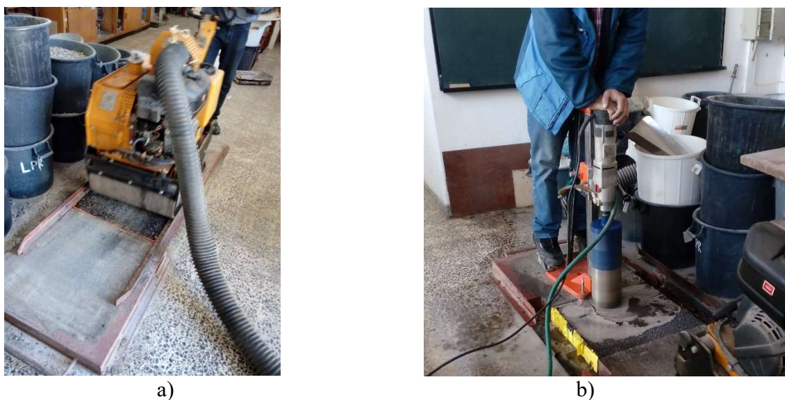
Figura 3.4 - Produção de laje por compactação de rolos: a) Processo de compactação de rolos; b) Processo de extração por caroteamento
