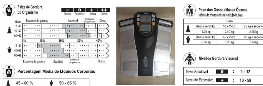
Figura 6. Balança de bioimpedância (TANITA® BC-545N InnerScan) utilizada para avaliação da composição corporal dos participantes e valores de referência (Modificado do anexo II).
