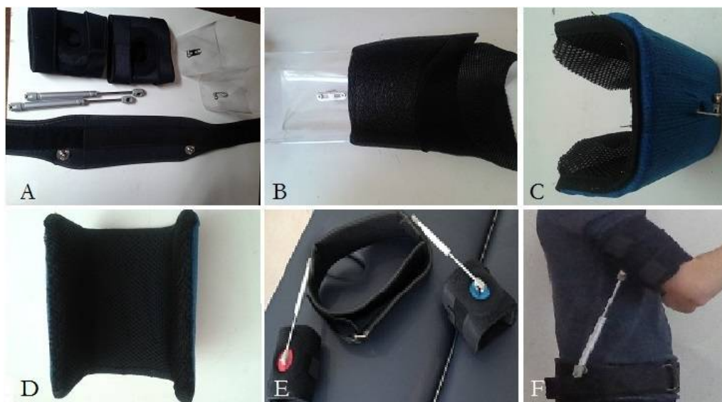
Figura 4. Protótipo personalizado avaliado neste estudo. A) Peças para montagem. B, C, D) Etapas da aplicação de forro à braçadeira. E) Protótipo montado. F) Demonstração da utilização por um participante do estudo.
