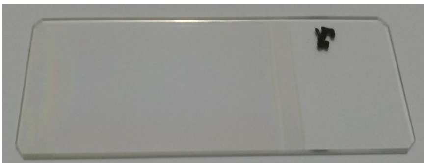
Figura 39 - Filme fino com cinco camadas após o processo de recobrimento apenas seco em estufa
