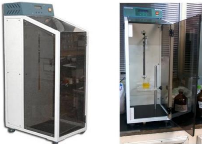
Figura 20 - Equipamento de dip-coating Marconi (MA 765)
