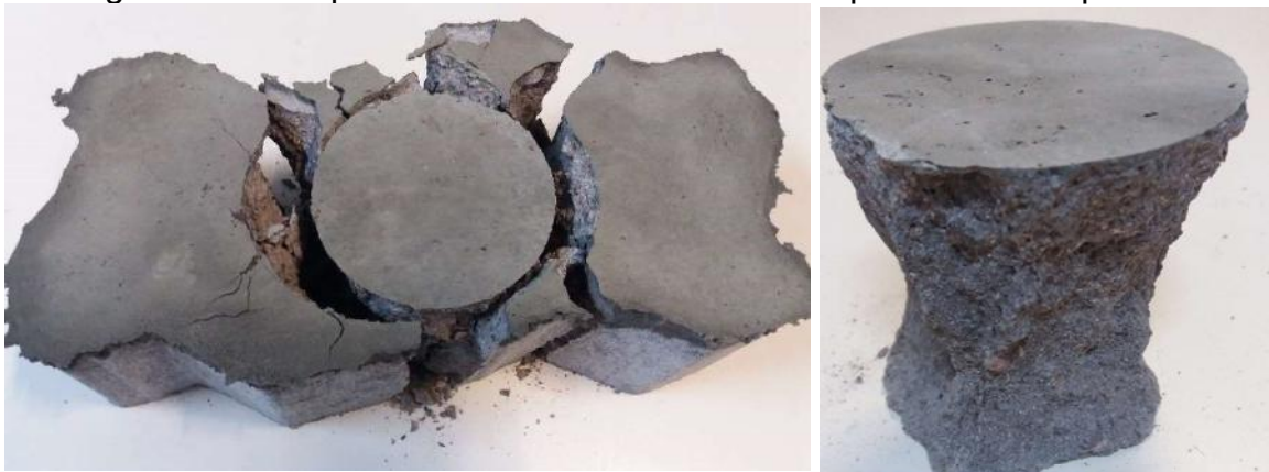
Figura 55 - Comportamento das amostras no rompimento à compressão
