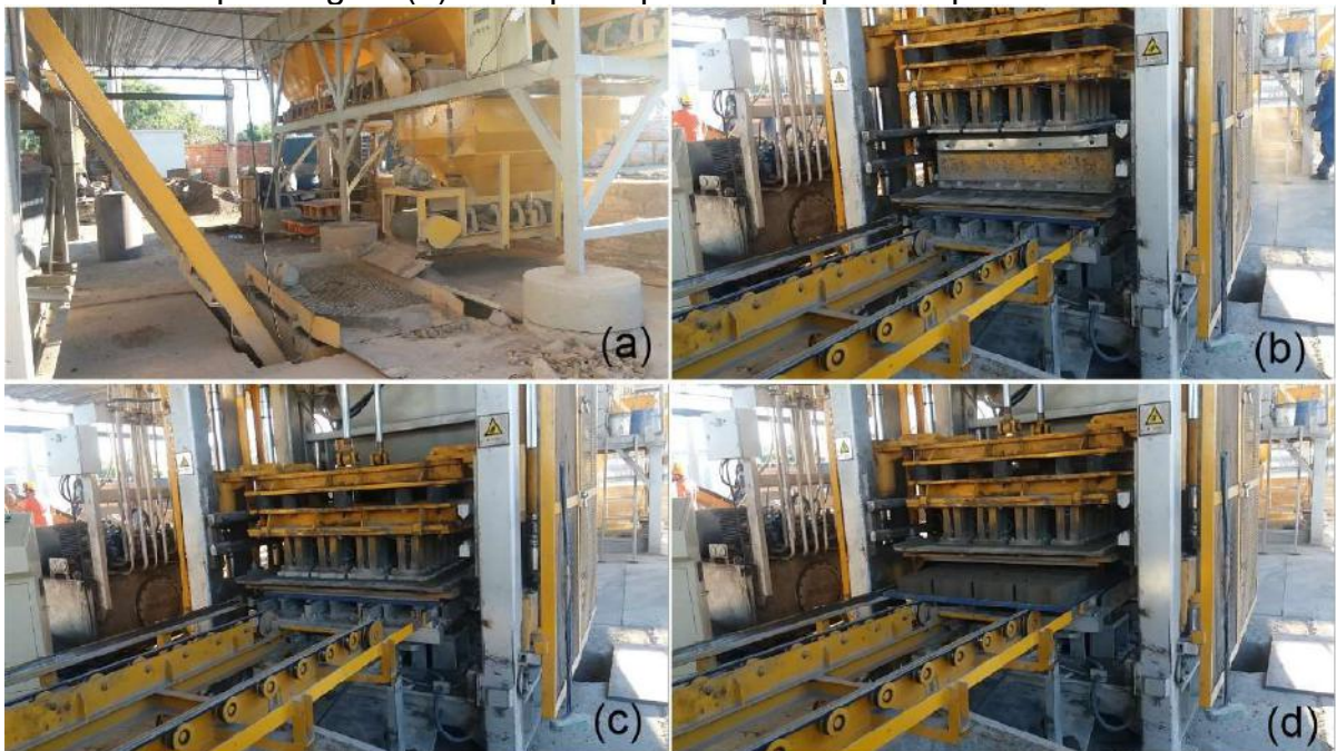
Figura 16 - (a) Balanças e misturador (b) Preenchimento da matriz (c) Vibro prensagem (d) Transporte por correia para empilhamento
