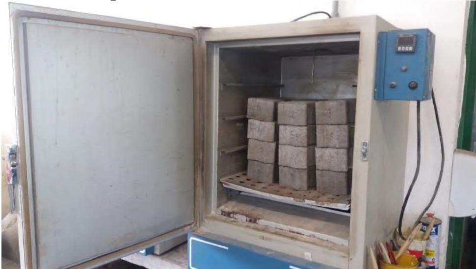
Figura 40 - Amostras Secando em Estufa
