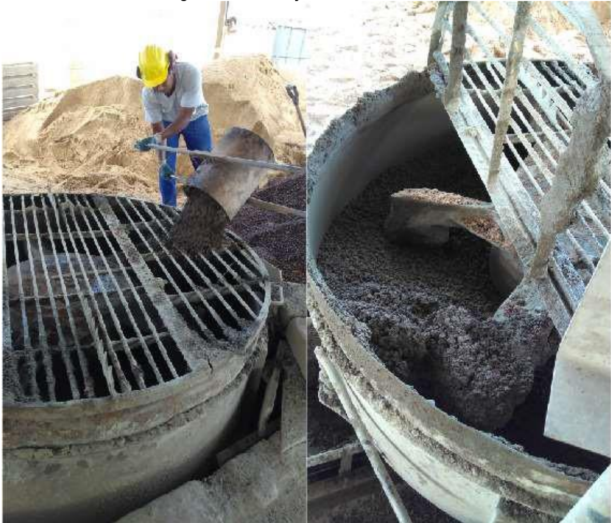
Figura 11 - Produção de concreto seco
