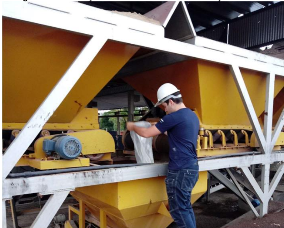
Figura 34 - Inserção do Vidro Moído na Balança Dosadora
