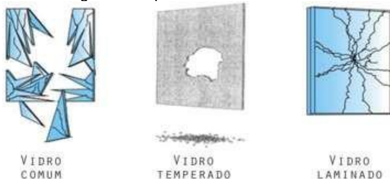
Figura 5 - Tipos de Fraturas do Vidro
