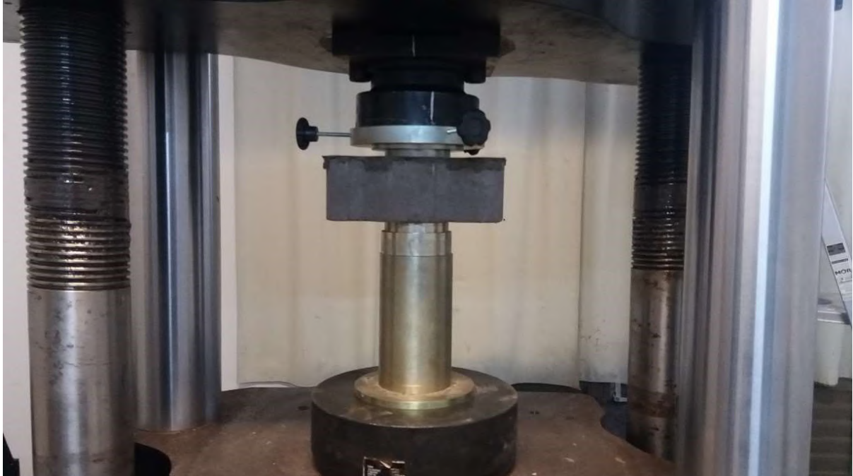
Figura 51 - Dispositivo de Ensaio com diâmetro de 85mm
