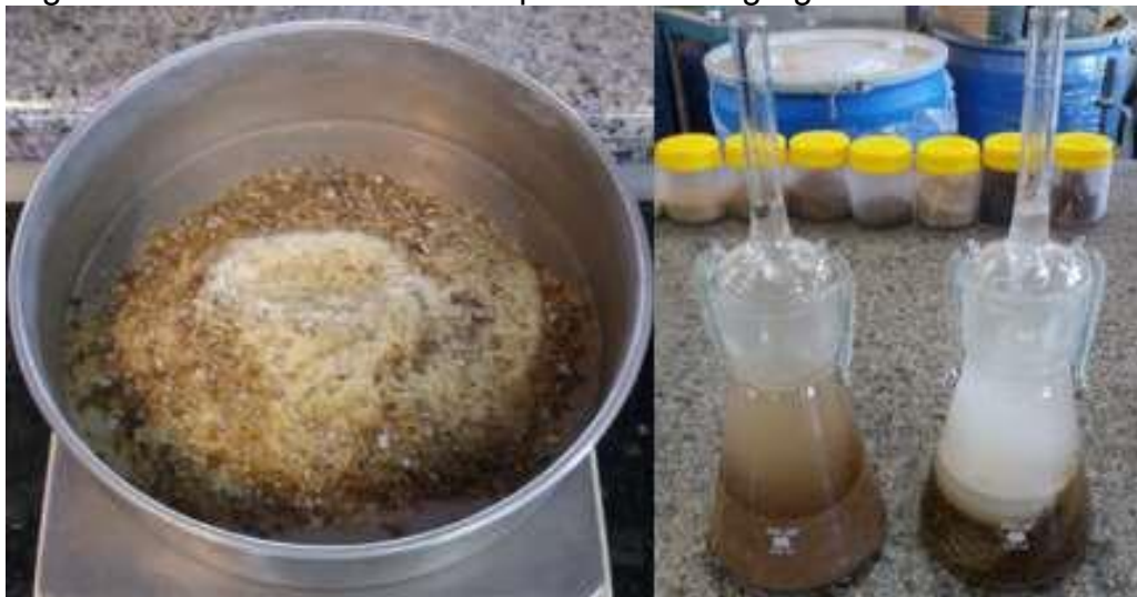
Figura 45 - Ensaio de Massa Específica dos Agregados em Andamento
