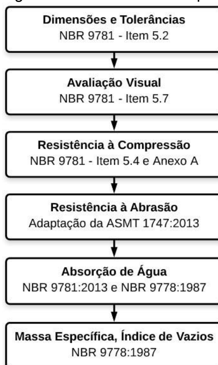
Figura 35 - Estrutura da Etapa 3
