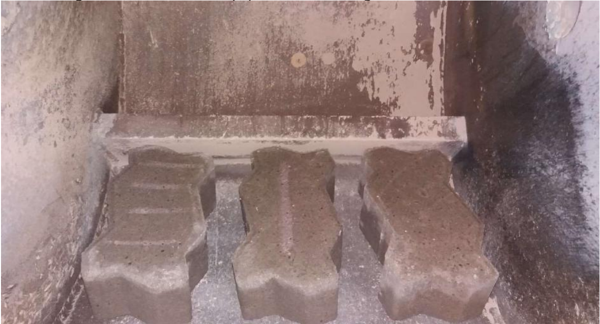
Figura 56 - Interior do equipamento Los Angeles com as 3 amostras
