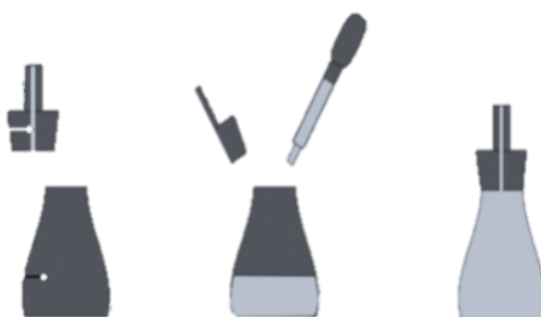
Figura 3 Representação esquemática do modo de utilização de um picnómetro de líquidos
