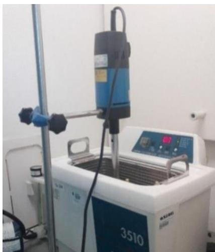
**Figura 6** - Disposição do Ultraturrax dentro do banho de ultrassons
