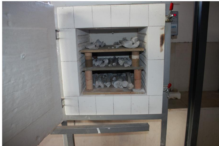
Figura 1. Disposição dos ossos no forno elétrico Barracha K-3 trifásico 14A.
