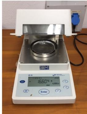
**Figura 8** - Balança termogravimétrica
