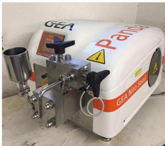
**Figura 13** - Homogeneizador GEO Niro Soavi, PANDA Plus 2000
