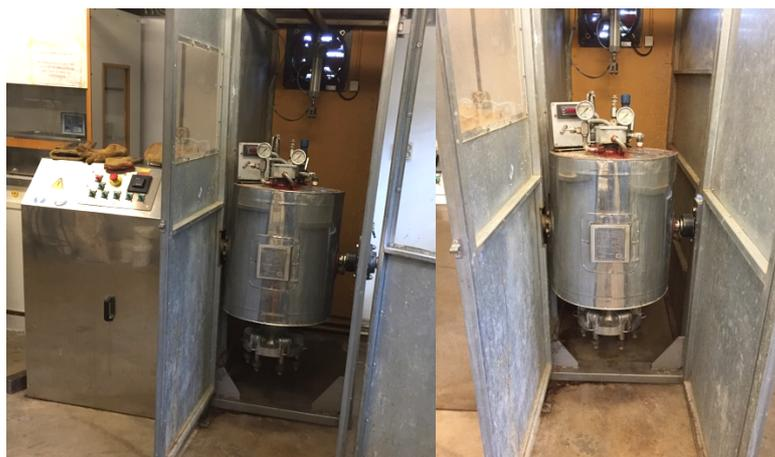
**Figura 9** - Reator de pressão para cozimento
