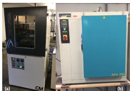
Figura 14 - Câmara climática (a) e estufa (b)
