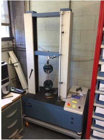
**Figura 20** - Máquina de teste universal
