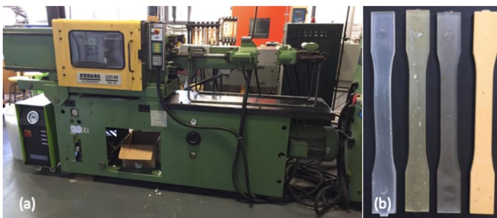
Figura 18 - (a) Injetora Arburg Allrounder 220M 350-90; (b) Provetes de ensaio de tração e flexão
