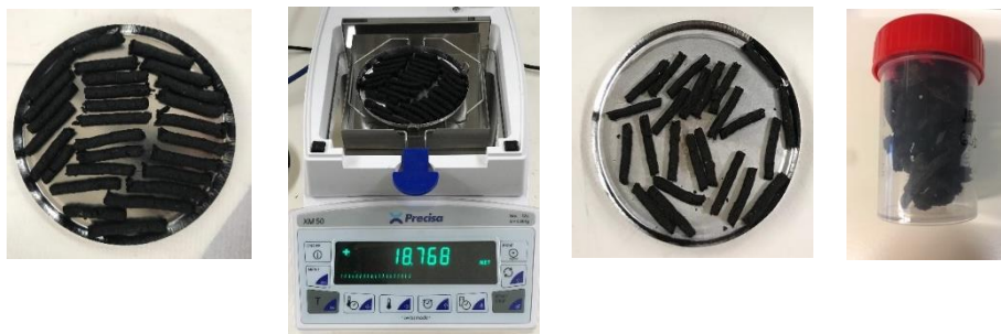
Figura 4.7 – Secagem das amostras de biossólido: a) biossólido não seco, b) balança de secagem, c) biossólido após secagem, d) armazenamento do biossólido seco.
