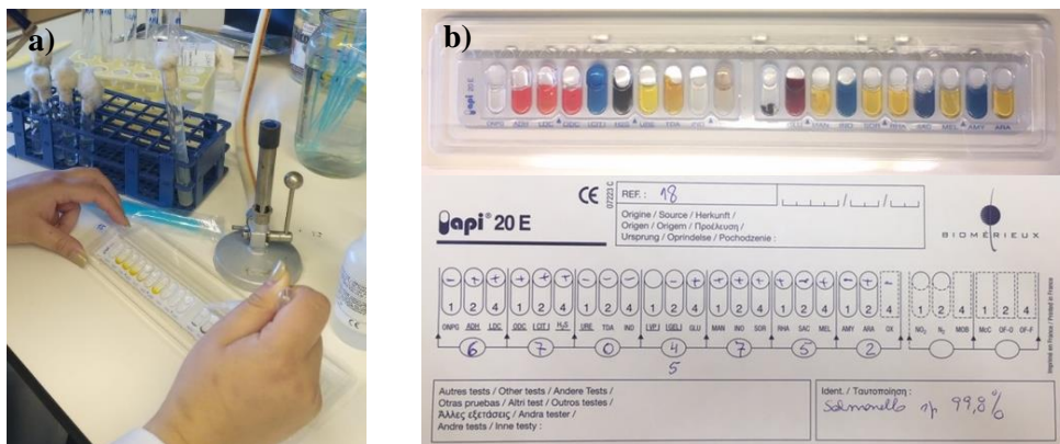
Figura 4.6 – API ® 20E para confirmação bioquímica de Salmonella spp.: a) preparação, b) leitura e identificação através da aplicação apiweb ™ .
