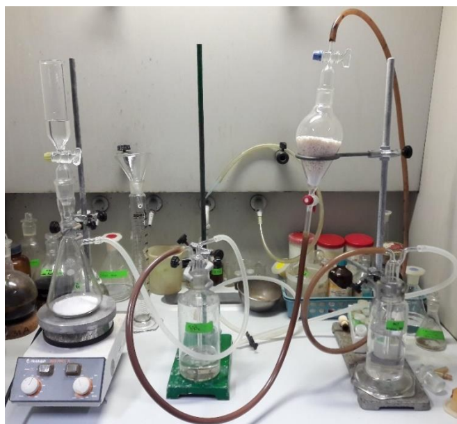
Figura 2.2. Montagem utilizada para a obtenção da solução etérea de ácido clorídrico.
